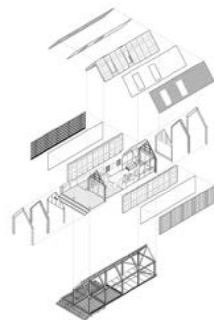
Axonométrie - bâtiment circulaire par Arup © Arup Associates
