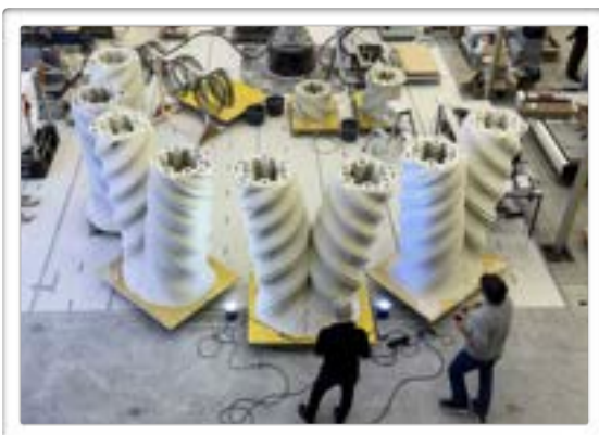
Éléments de la Tor Alva, imprimés en 3D © Benjamin Dillenburger
